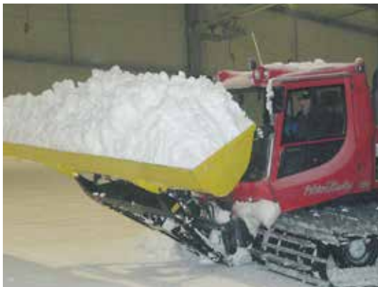
Frontmontert snøskuffe til å flytte snø over kortere avstander. Denne metoden gir lite svinn av snø sammenlignet med å dose snø over samme avstand.
