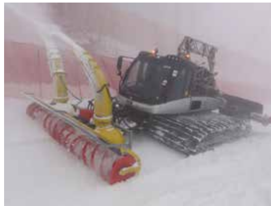
Frontmontert snøfres for å kaste nysnø ut av renntrase over A-nett.
